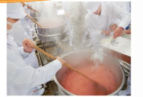
春はイチゴの季節。大きな二重釜を使って大量のイチゴをジャムに加工します。できた製品は食品加工科の主力商品となります。
